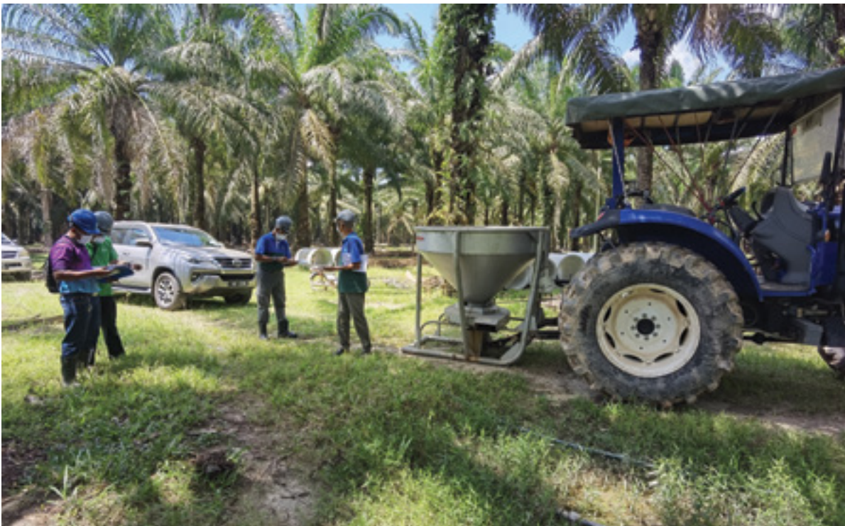
Fertilizer Spreader Alat ini disambungkan kepada traktor dan digunakan untuk menabur baja di dalam ladang (kawasan rata dan beralun)
